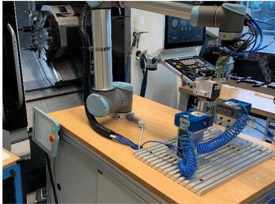
**Abbildung 21: Demonstrator mit Aufspannplatte und Spannsystem**
