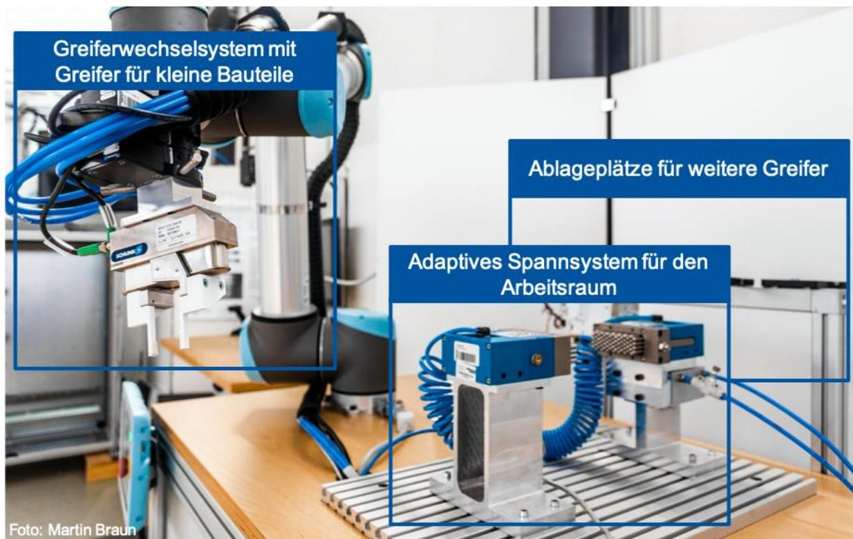
**Abbildung 6: Ausgewähltes Greiferwechselsystem und adaptives Spannsystem**
