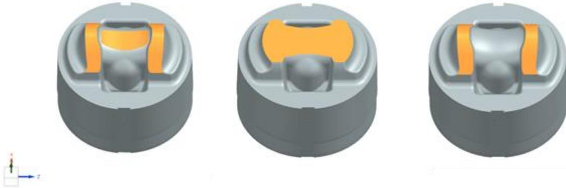
**Abbildung 46: Demonstrator mit farblich markierten Oberflächen, an denen Material abgetragen wurde**
