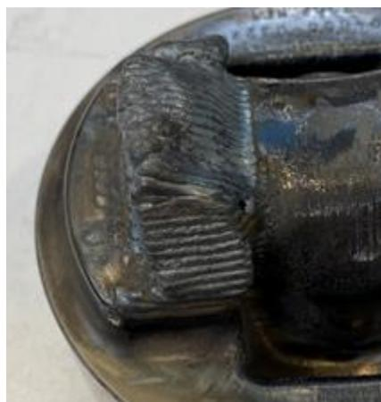
**Abbildung 49: Flanke eines Demonstrators nach der Reparatur
