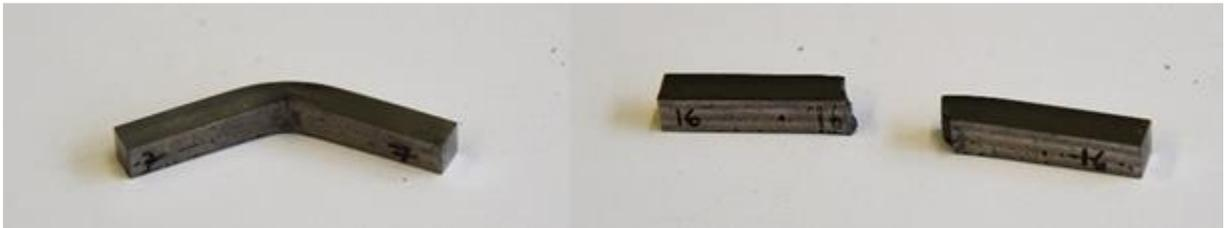
**Abbildung 27: Biegemodul und Biegefestigkeit für Typ 1 und Typ 2 (mit 50 % Substratmaterial) der verschiedenen Konzentrationen mit Titankarbid**
