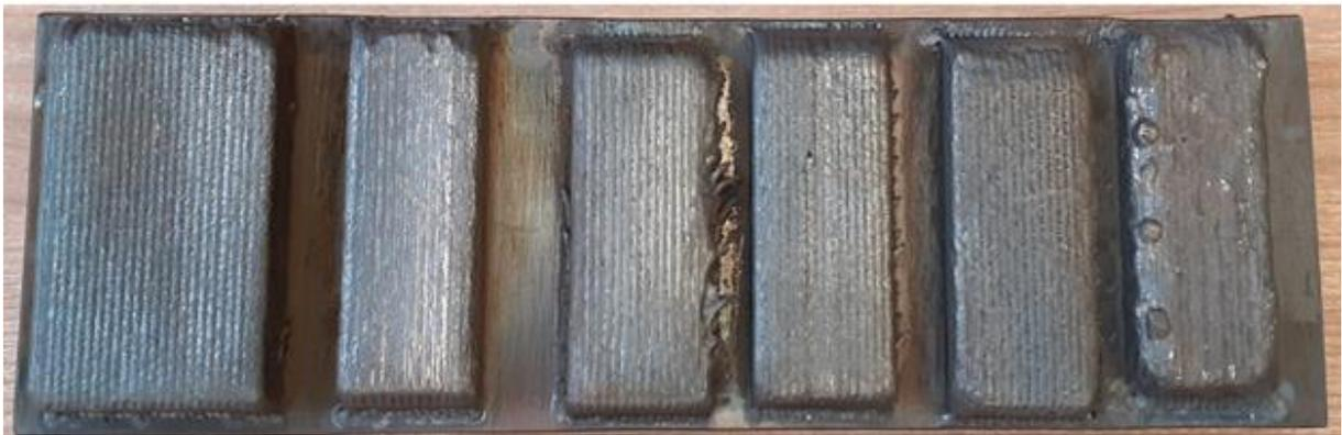
**Abbildung 13: Aufgeschweißte Blöcke unterschiedlicher Größe für die Herstellung der Probekörper**
